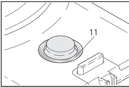
Je nach Art des Füllgutes kann ein Wechsel erforderlich sein, ohne dass die Filtertüte bis oben gefüllt ist. Die Filteranzeige erscheint nicht bei niedriger Saugkrafteinstellung. Sie sollte regelmäßig bei hoher Saugkraft überprüft werden.
