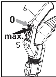
Schalten Sie nun das Gerät durch Drücken des Schaltknopfes (10) ein. Nach dem Einschalten leuchten zwei LED neben dem Einschaltknopf. Ihr **SEBO PROFESSIONAL D9** befindet sich nun im Start-Modus. Bei den SEBO PROFESSIONAL D9 Modellen lässt sich die Saugkraft mit den Plus- und Minus-Tasten im Handgriff (6) von 0 bis max. regulieren.
