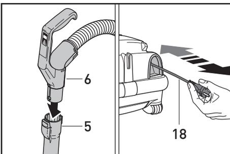
Das Teleskoprohr (5) sollte vor Arbeitsbeginn auf die gewünschte Arbeitshöhe eingestellt werden. Dies geschieht durch Betätigung der Schiebepaste (21). Schalten Sie nun das Gerät durch Drücken des Schaltknopfes (11) ein. Ihr SEBO AIRBELT™ K läuft besonders sanft an.
